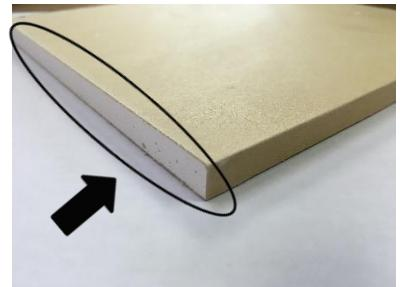
専用シーラー原液だと粘度が高すぎて奥までしっかり塗れない場合があるので、3倍液を使用して下さい。
